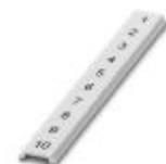
Repérage ZB, plat, Rubans, blanc, repéré, impression transversale: numérotation continue 1 ... 10, 11 ... 20, etc. jusqu'à 91 ... 100, type de montage: encliquetage dans la rainure de repérage plate, pour bloc de jonction au pas de : 5 mm, surface utile: 5,15 x 5,15 mm, Nombre d'étiquettes: 10
