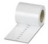
Repères pour blocs de jonction, Rouleau, blanc, vierge, repérable avec : THERMOMARK ROLL 2.0, THERMOMARK ROLL, THERMOMARK ROLL X1, THERMOMARK ROLLMASTER 300/600, THERMOMARK X1.2, THERMOMARK S1.1, perforé, type de montage: encliquetage dans la rainure de repérage universelle, encliquetage dans la rainure de repérage plate, pour bloc de jonction au pas de : 6,2 mm, surface utile: 6,35 x 6,15 mm, Nombre d'étiquettes: 16000
