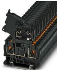
Bloc de jonction-fusibles, type de fusible: Verre / Céramique / ..., nombre de pôles: 1, type de raccordement: Raccordement Push-in, section : 0,2 mm<sup>2</sup>- 6 mm<sup>2</sup>, AWG: 24 - 10, intensité nominale: 6,3 A, tension nominale: 400 V, largeur: 6,2 mm, type de fusible: G / 5 x 20, type de montage: NS 35/7,5, NS 35/15, coloris: noir
