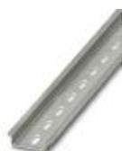
Profilé percé, Profil standard, largeur: 35 mm, hauteur: 7,5 mm, selon EN 60715, matériau: Acier, galvanisé, traité par passivation couche épaisse, longueur: 2000 mm, coloris: argenté
