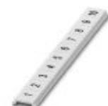
Repérage ZB, plat, Rubans, blanc, repéré, impression longitudinale: numérotation continue 1 ... 10, 11 ... 20, etc. jusqu'à 491 ... 500, type de montage: encliquetage dans la rainure de repérage plate, pour bloc de jonction au pas de : 5 mm, surface utile: 5,15 x 5,15 mm, Nombre d'étiquettes: 10
