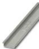
Profilé plein, Profil standard, largeur: 35 mm, hauteur: 7,5 mm, selon EN 60715, matériau: Acier, galvanisé, traité par passivation couche épaisse, longueur: 2000 mm, coloris: argenté
