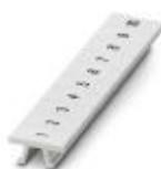
Repérage ZB, Rubans, blanc, repéré, impression longitudinale: numérotation continue 1 ... 10, 11 ... 20, etc. jusqu'à 491 ... 500, type de montage: encliquetage dans la rainure de repérage élevée, pour bloc de jonction au pas de : 5,2 mm, surface utile: 5,15 x 10,5 mm, Nombre d'étiquettes: 10
