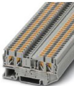
Blocs de jonction simple, tension nominale: 800 V, intensité nominale: 24 A, type de raccordement: Raccordement Push-in, nombre de connexions: 4, section : 0,14 mm<sup>2</sup> - 4 mm<sup>2</sup>, AWG: 26 - 12, largeur: 5,2 mm, hauteur: 35,3 mm, coloris: gris, type de montage: NS 35/7,5, NS 35/15
