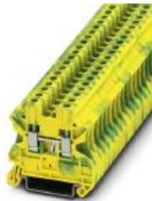
Bloc de jonction pour conducteur de protection, type de raccordement: Raccordement vissé, nombre de connexions: 2, section : 0,14 mm<sup>2</sup> - 6 mm<sup>2</sup>, AWG: 26 - 10, largeur: 6,2 mm, hauteur: 46,9 mm, coloris: vert/jaune, type de montage: NS 35/7,5, NS 35/15
