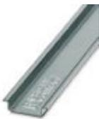
Profilé plein, Profil standard, largeur: 35 mm, hauteur: 7,5 mm, selon EN 60715, matériau: Acier, galvanisé, passivation blanche, longueur: 2000 mm, coloris: argenté
