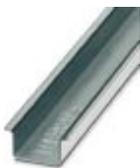
Profilé plein, Profil standard, largeur: 35 mm, hauteur: 15 mm, similaire à EN 60715, matériau: Acier, galvanisé, passivation blanche, longueur: 2000 mm, coloris: argenté
