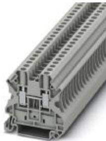
Blocs de jonction simple, tension nominale: 1000 V, intensité nominale: 32 A, type de raccordement: Raccordement vissé, nombre de connexions: 2, section : 0,14 mm<sup>2</sup> - 6 mm<sup>2</sup>, AWG: 26 - 10, largeur: 6,2 mm, hauteur: 46,9 mm, coloris: gris, type de montage: NS 35/7,5, NS 35/15
