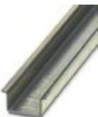
Profilé plein, Profil standard, largeur: 35 mm, hauteur: 15 mm, similaire à EN 60715, matériau: Acier, galvanisé, traité par passivation couche épaisse, longueur: 2000 mm, coloris: argenté
