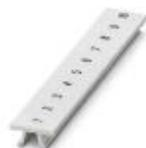
Repérage ZB, Rubans, blanc, repéré, repérable avec : CMS-P1-PLOTTER, impression longitudinale: numérotation continue 1 ... 10, 11 ... 20, etc. jusqu'à 491 ... 500, type de montage: encliquetage dans la rainure de repérage élevée, pour bloc de jonction au pas de : 6,2 mm, surface utile: 6,15 x 10,5 mm, Nombre d'étiquettes: 10
