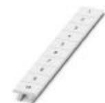
Repérage ZB, Rubans, blanc, repéré, repérable avec : CMS-P1-PLOTTER, impression transversale: numérotation continue 1 ... 10, 11 ... 20, etc. jusqu'à 91 ... 100, type de montage: encliquetage dans la rainure de repérage élevée, pour bloc de jonction au pas de : 8,2 mm, surface utile: 10,5 x 8,15 mm, Nombre d'étiquettes: 10
