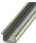
Profilé plein, Profil standard, largeur: 35 mm, hauteur: 15 mm, similaire à EN 60715, matériau: Acier, galvanisé, traité par passivation couche épaisse, longueur: 2000 mm, coloris: argenté
