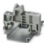
Butée, largeur: 9,5 mm, hauteur: 35,3 mm, matériau: PA, longueur: 50,5 mm, Montage sur profilé NS 32 ou NS 35, coloris: gris
