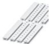
Repères pour blocs de jonction, Rubans, blanc, repéré, repérable avec : CMS-P1-PLOTTER, longitudinal: L1, L2, L3, N, PE, L1, L2, L3, N, PE, type de montage: encliquetage dans la rainure de repérage élevée, pour bloc de jonction au pas de : 8,2 mm, surface utile: 10,5 x 8,15 mm, Nombre d'étiquettes: 10
