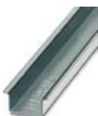
Profilé plein, Profil standard, largeur: 35 mm, hauteur: 15 mm, similaire à EN 60715, matériau: Acier, galvanisé, passivation blanche, longueur: 2000 mm, coloris: argenté
