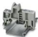
Butée, largeur: 9,5 mm, hauteur: 35,3 mm, matériau: PA, longueur: 50,5 mm, Montage sur profilé NS 32 ou NS 35, coloris: gris
