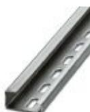
Profilé percé, Profilé G, largeur: 32 mm, hauteur: 15 mm, selon EN 60715, matériau: Acier, galvanisé, traité par passivation couche épaisse, longueur: 2000 mm, coloris: argent
