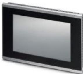
Ecran tactile avec TFT 17,8 cm/7"-ecran (capacitif projeté (PCAP)), 800 x 480 pixel(s) (WVGA), 16,7 millions de couleurs, Arm® Cortex®-A8, 1000 MHz, 2x USB hôte 2.0, 1x Ethernet (10/100/ MBit/s), RJ45, Windows® Embedded Compact 7 et logiciel utilisateur: Visu+. (système de bus: sans)
