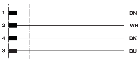
Affectation des contacts du connecteur mâle M12
