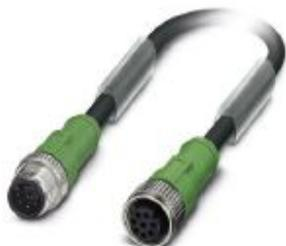
Câbles pour capteurs/actionneurs, 8-pôles, PUR exempt d'halogène, gris-noir RAL 7021, connecteur mâle droit M12, détrompage: A, sur connecteur femelle droit M12, détrompage: A, longueur de câble: 3 m
