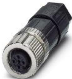
Connecteur, Universel, 5-pôles, non blindé, connecteur femelle droit M12, Détrompage: A, Raccordement Push-in, matériau de la molette: Zinc moulé sous pression, nickelé, diamètre extérieur du câble 4 mm ... 8 mm
