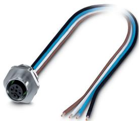
Connecteurs encastrables, Universel, 4-pôles, connecteur femelle, M12, détrompage A, Montage sur face avant, M16 x 1,5, Cordons individuels, longueur de câble: 0,5 m, 0,34 mm<sup>2</sup>, Cordon TPE
