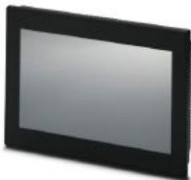
Ecran tactile avec 25.9 cm / 10.2" TFT-ecran (résistive analogique (polyester)), 16,7 millions de couleurs, Arm® Cortex®-A9, 1 GHz, 1 USB hôte 2.0, 1x Ethernet (10/100/ MBit/s), RJ45, Yocto/Linux et logiciel utilisateur: Otter Browser. (système de bus: sans)
