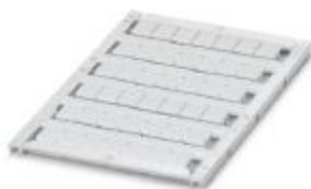
Repères pour blocs de jonction, Plaque, blanc, vierge, repérable avec : TOPMARK NEO, LASER TOPMARK, BLUEMARK ID COLOR, BLUEMARK ID, BLUEMARK CLED, THERMOMARK PRIME, THERMOMARK CARD 2.0, THERMOMARK CARD, type de montage: encliquetage dans la rainure de repérage élevée, pour bloc de jonction au pas de : 8,2 mm, surface utile: 7,6 x 10,5 mm, Nombre d'étiquettes: 42
