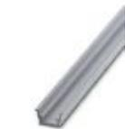
Profilé plein, Profil standard, largeur: 35 mm, hauteur: 15 mm, similaire à EN 60715, matériau: Aluminium, aucun revêtement, longueur: 2000 mm, coloris: argenté
