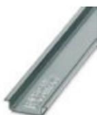
Profilé plein, Profil standard, largeur: 35 mm, hauteur: 7,5 mm, selon EN 60715, matériau: Aluminium, aucun revêtement, longueur: 2000 mm, coloris: argenté
