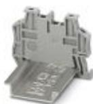
Crampon terminal à montage rapide, pour profilé NS 35/7,5 ou NS 35/15, avec possibilité de repérage, possibilité de montage pour FBS...5, FBS...6, KSS 5, KSS 6, largeur : 5,15 mm, coloris : gris
