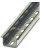
Profilé percé, Profil standard, largeur: 35 mm, hauteur: 15 mm, similaire à EN 60715, matériau: Acier, galvanisé, traité par passivation couche épaisse, longueur: 2000 mm, coloris: argenté
