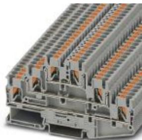
Bloc de jonction à plusieurs étages, type de raccordement: Raccordement Push-in, section : 0,14 mm<sup>2</sup> - 4 mm<sup>2</sup>, AWG: 26 - 12, largeur: 5,2 mm, coloris: gris, type de montage: NS 35/7,5, NS 35/15
