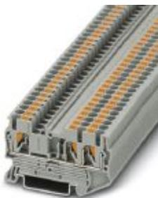
Blocs de jonction simple, tension nominale: 800 V, intensité nominale: 24 A, type de raccordement: Raccordement Push-in, nombre de connexions: 3, section : 0,14 mm<sup>2</sup> - 4 mm<sup>2</sup>, AWG: 26 - 12, largeur: 5,2 mm, hauteur: 35,2 mm, coloris: gris, type de montage: NS 35/7,5, NS 35/15
