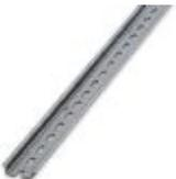
Profilé percé, Profil standard, largeur: 35 mm, hauteur: 7,5 mm, selon EN 60715, matériau: Acier, galvanisé, passivation blanche, longueur: 2000 mm, coloris: argenté
