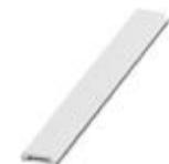
Repérage ZB, plat, à commander : par bandes, blanc, impression selon les indications du client, type de montage: encliquetage dans la rainure de repérage plate, pour bloc de jonction au pas de : 5 mm, surface utile: 5,15 x 5,15 mm, Nombre d'étiquettes: 10
