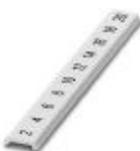
Repérage ZB, plat, Rubans, blanc, repéré, impression longitudinale: numérotation continue 2 ... 20, 22 ... 40, etc. jusqu'à 82 ... 100, type de montage: encliquetage dans la rainure de repérage plate, pour bloc de jonction au pas de : 5 mm, surface utile: 5,15 x 5,15 mm, Nombre d'étiquettes: 10
