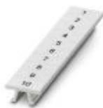
Repérage ZB, blanc, impression transversale: numérotation continue 1 ... 10, 11 ... 20, etc. jusqu'à 491 ... 500, type de montage: encliquetage dans la rainure de repérage élevée, pour bloc de jonction au pas de : 5,2 mm, surface utile: 5,15 x 10,5 mm
