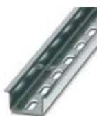
Profilé percé, Profil standard, largeur: 35 mm, hauteur: 15 mm, similaire à EN 60715, matériau: Acier, galvanisé, passivation blanche, longueur: 2000 mm, coloris: argenté
