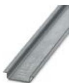
Profilé plein, Profil standard, largeur: 35 mm, hauteur: 7,5 mm, selon EN 60715, matériau: Acier, galvanisé, longueur: 2000 mm, coloris: argenté
