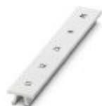
Repérage ZB, Rubans, blanc, repéré, impression longitudinale: L1, L2, L3, N, PE, type de montage: encliquetage dans la rainure de repérage élevée, pour bloc de jonction au pas de : 15,2 mm, surface utile: 10,5 x 15,1 mm, Nombre d'étiquettes: 5
