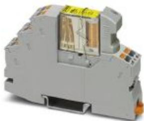
Module à relais prémonté avec raccordement Push-in, comprenant : une embase de relais, un relais de sécurité avec contacts forcés selon DIN EN 61810-3, un module antiparasite et d'affichage enfichable avec étrier de fixation, type de contact : 2 contacts inverseurs, tension d'entrée : 24 V DC
