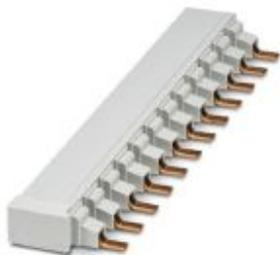
Barre collectrice pour disjoncteur de puissance TMC 81... (monophasé). Pas de 17,8 mm, jusqu'à 57 pôles. Conçue pour 80 A (alimentation finale), 1000 V AC/DC. Classée UL508 pour le raccordement de disjoncteurs de puissance avec homologation UL 489.
