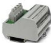
Module VARIOFACE, avec deux barres collectrices de potentiel (P1, P2) pour la répartition du potentiel, se monte sur profilé NS 35. Largeur du module 70,4 mm.
