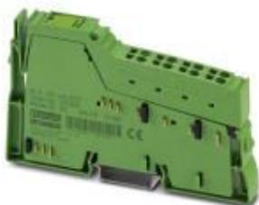
Inline ECO, Module d'acquisition de la température, Entrées UTH analogiques: 4 (Type K), connectique: 2 fils, vitesse de transmission dans le bus local: 500 kBit/s, indice de protection: IP20, connecteur Inline compris
