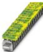
Bloc de jonction, type de raccordement: Raccordement vissé, courant de charge: 41 A, section : 0,5 mm<sup>2</sup> - 6 mm<sup>2</sup>, largeur: 7 mm, coloris: vert/jaune
