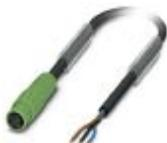
Câbles pour capteurs/actionneurs, 3-pôles, PUR exempt d'halogène, gris-noir RAL 7021, extrémité libre, sur Connecteur femelle droite M8 Snap-In, longueur de câble: 3 m, avec embouts
