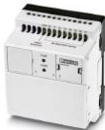
Unité de base Nanoline 24VDC. Equipée de 8 entrées TOR, 2 entrées analogiques (0-10 V) et 4 canaux TOR de sortie PNP. Des canaux I/O peuvent être ajoutés et jusqu'à 3 modules d'extension I/O peuvent être posés. Des modules de communication optionnels permettent un raccord au réseau ou un raccord série. Un appareil de commande disponible en option fournit une interface utilisateur. La programmation a lieu via le nanoNavigator.
