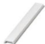
Repérage ZB, plat, Rubans, blanc, vierge, repérable avec : PLOTMARK, CMS-P1-PLOTTER, type de montage: encliquetage dans la rainure de repérage plate, pour bloc de jonction au pas de : 10,15 mm, surface utile: 4 fois 10,15 x 5 mm et 1 fois 5,8 x 5 mm, Nombre d'étiquettes: 50
