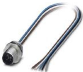
Connecteur mâle encastrable pour capteurs et actionneurs, 5 pôles, M12, détrompage A, montage vissé/sur face avant, filetage Pg9, avec cordon TPE de 0,5 m, 5 x 0,34 mm<sup>2</sup>
