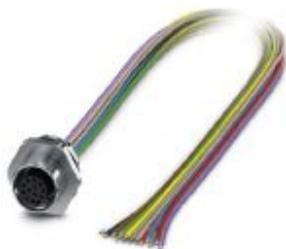
Connecteurs encastrables, Universel, 8-pôles, connecteur femelle, M12, détrompage A, Montage sur face avant, M16 x 1,5, Cordons individuels, longueur de câble: 0,5 m, 0,25 mm<sup>2</sup>, Cordon TPE
