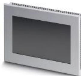
Ecran tactile avec TFT 17,8 cm/7"-ecran (résistive analogique (polyester)), 800 x 480 pixel(s) (WVGA), 262144 couleurs, Arm® Cortex®-A53, 4x 1.2 GHz, 2x USB hôte 2.0, 1x Ethernet (10/100/ MBit/s), RJ45, Yocto/Linux et logiciel utilisateur: Chromium Browser. (système de bus: sans)
